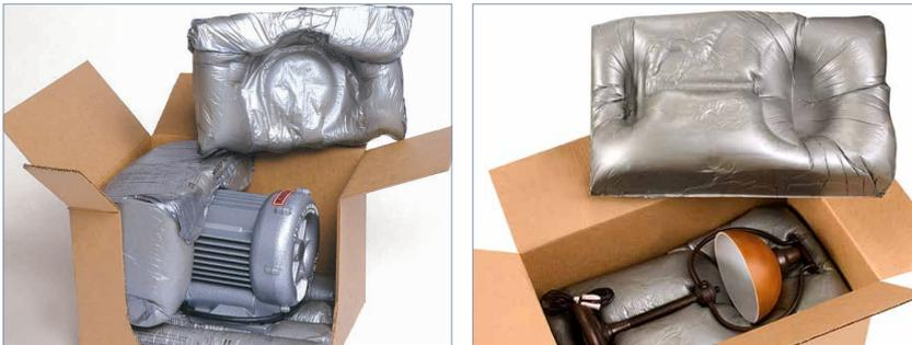
Karton mit Instamate®-Folie auskleiden, einschäumen, ausdehnenden Schaum mit überlappenden Folienenden zudecken und das Verpackungsgut einlegen.
