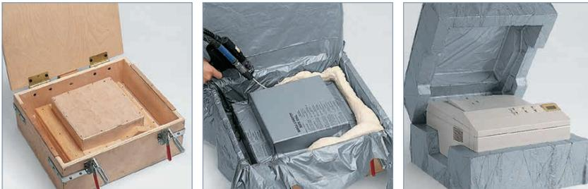
Negativform des zu verpackenden Produktes aus Holz o.Ä. anfertigen.
